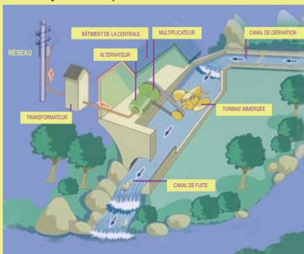
Principe de fonctionnement d'une centrale hydroélectrique
